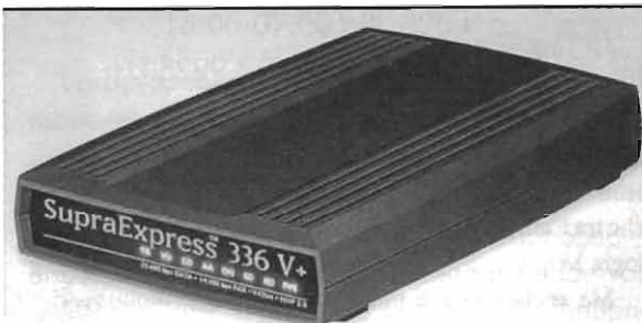
Esempio di MODEM esterno, uno dei più recenti modelli a 33.600 bps.
