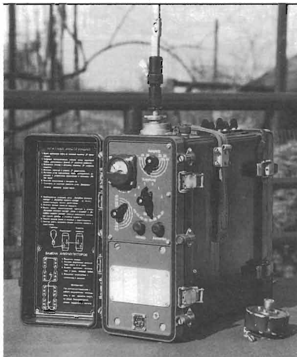
Foto 1 - Il lineare UM-2 con la sua antenna a stilo. In basso a destra è visibile l'adattatore per il connettore d'antenna del trasmettitore di pilotaggio.
