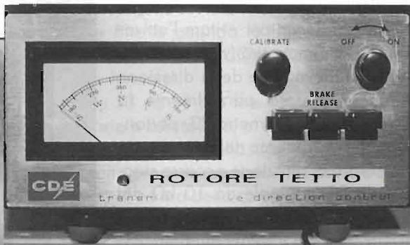
Foto 10 - Vista frontale del control-box con il quadrante dello strumento rifatto con trasferibili su cartoncino bianco.
